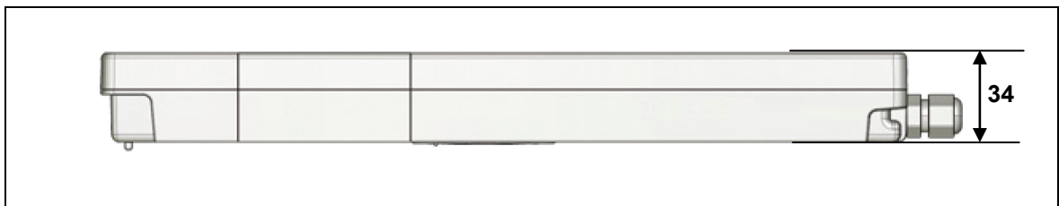
Abbildung 5 Maße des AG300, Seitenansicht (Angaben in mm)
