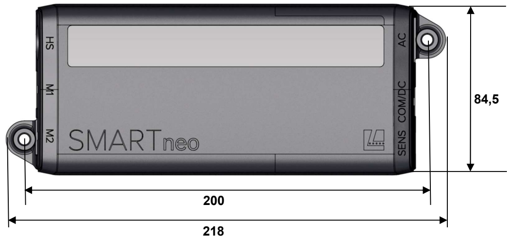
Abbildung 66 Steuerung SMARTneo / SMARTneo-pro, Draufsicht (Angaben in mm)
