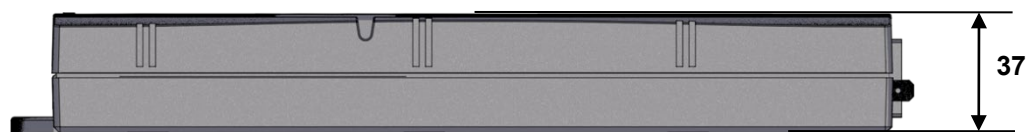
Abbildung 69 Steuerung COMPACT, Seitenansicht (Angaben in mm)
