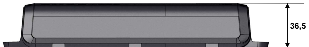
Abbildung 67 Steuerung SMARTneo / SMARTneo-pro, Seitenansicht (Angaben in mm)
