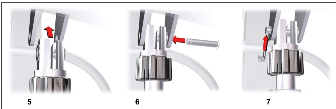
Abbildung 24 Montageschritte am Gabelkopf LR (Beispiel)
